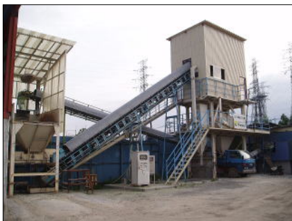
中建産業(株)のガラス再資源化プラントでは、ガラスカレット(ガラスのビーズ)を製造している
